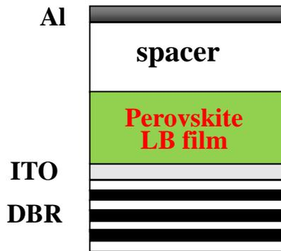
ペロブスカイト薄膜を用いたレーザー
